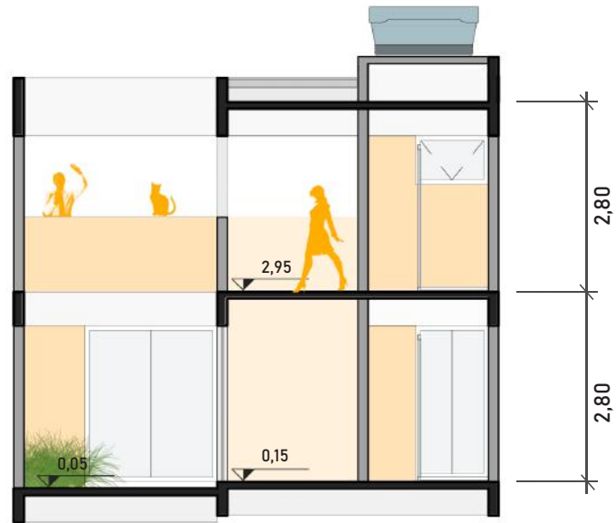
Corte Transversal, demonstrando a ventilação do banheiro ocorrendo, a escada metálica, a laje coberta e o afastamento de 1 metro para o uso da varanda no térreo.
