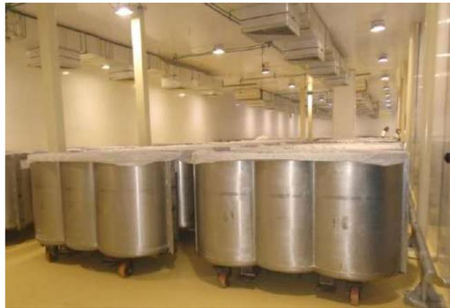
Figura 4 - Câmara de fermentação de produtos *Cream Cracker*.
