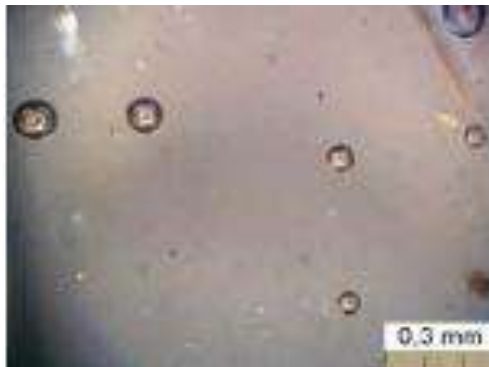
Figura IV.20. Fotomicrografia óptica do PC no estado fundido
