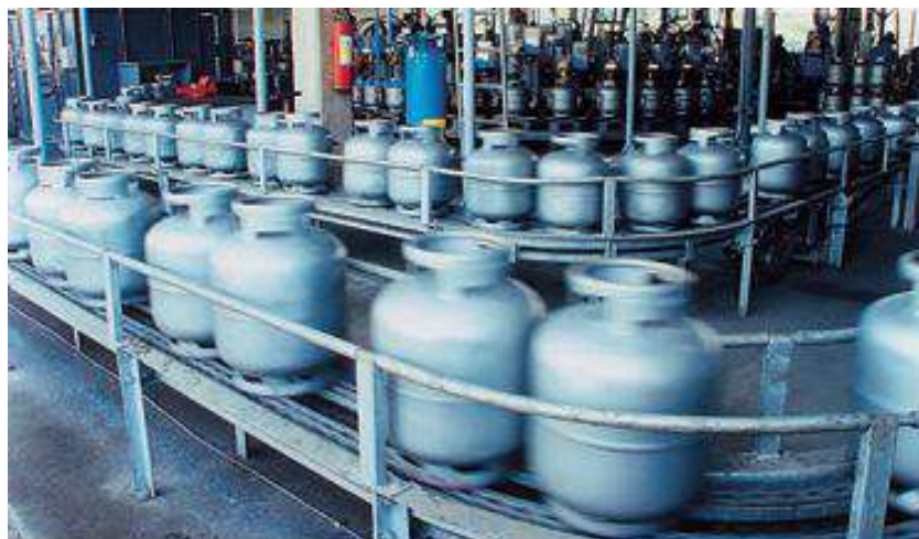
Figura 2 Unidade de envasamento de GLP.
