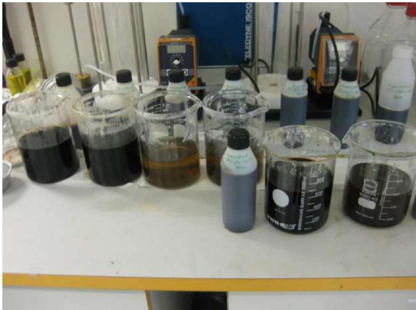
**Figura III.2. Terceira etapa, sedimentação; garrafas plásticas contendo o primeiro sobrenadante removido.**
