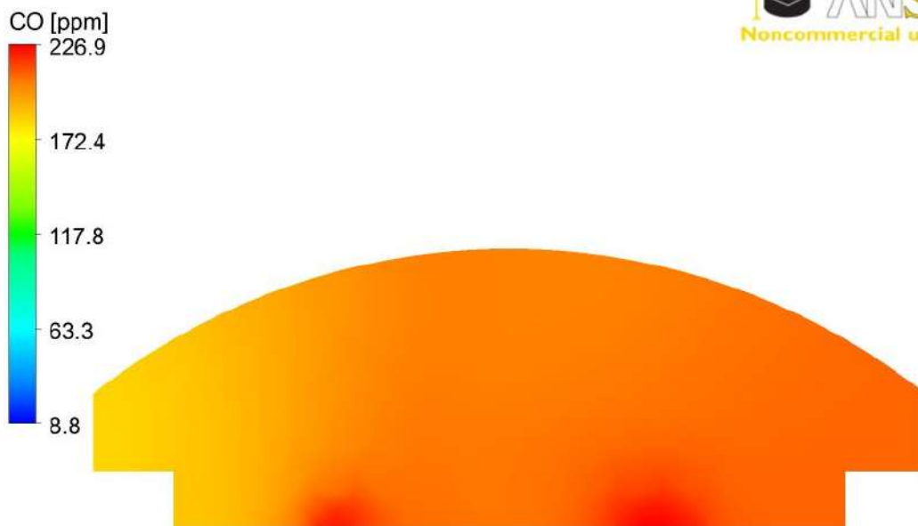
Figura 56 - Perfil de concentração de CO a 814,2 m da entrada no sentido Catumbi/Laranjeiras com os ventiladores desligados
