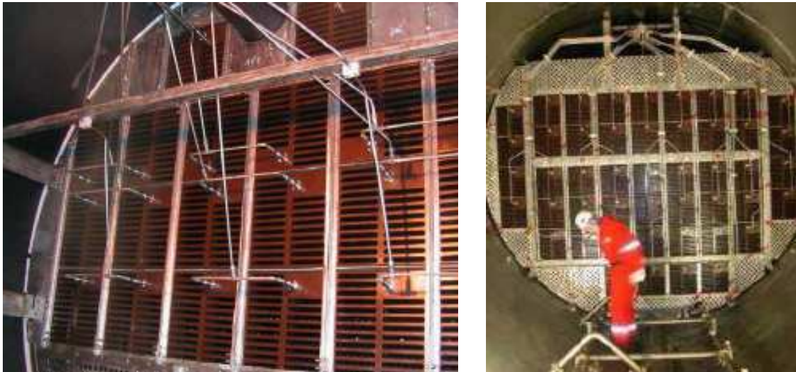
Figura 2-24: Detalhes da instalação VIEC no FPSO Munin no Mar da China Meridional.
