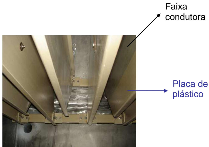
Figura 2-19: Foto do conjunto de eletrodos de um tratador eletrostático da Bacia de Campos.
