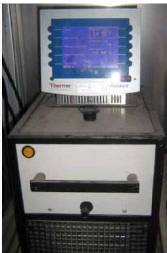
Figura III.2 - Banho de Refrigeração com Interface Local
