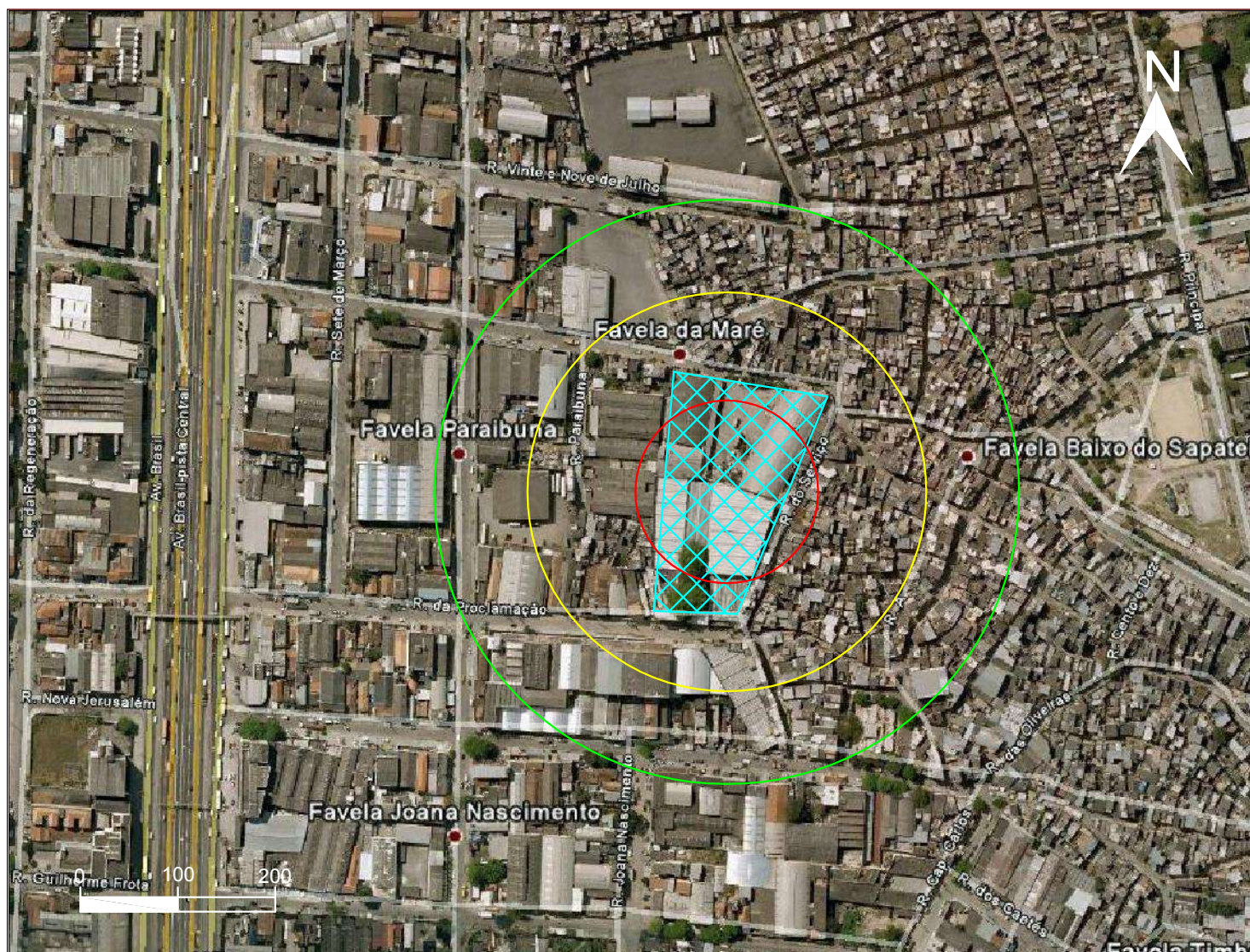
FIGURA 36: Alcances de sobrepressões para explosão no caso C
