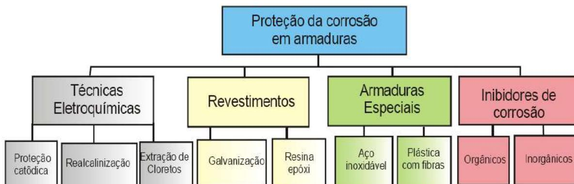
**Figura 11:** Sistemas de proteção e reparo da corrosão das armaduras nas estruturas de concreto (GONÇALVES, 2003)
