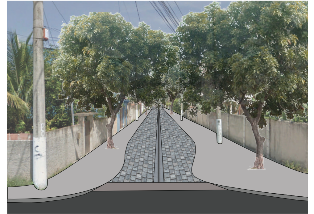
..... Via com intertravado nivelada com a calçada
