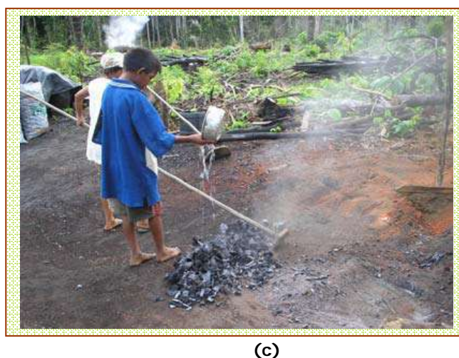
Figuras 4.3 - Produção de carvão vegetal em (a) caieira, (b) separação da terra, e (c) apagando o fogo do carvão com água (Silva, 2006)
