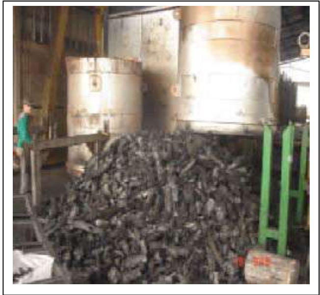
Figura 5.30 – Descarga mecanizada do cilindro metálico depositando carvão vegetal num vagão apropriado. (Bricarbras, 2006)
