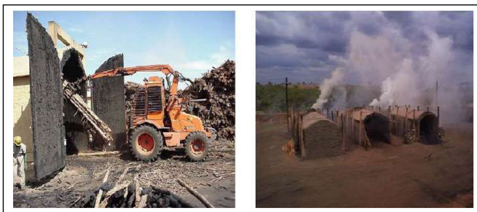
Figura 3.9 – Outro estágio de evolução: forno retangular (Missouri) de alvenaria (Pimenta, 2007 – citado por Santos, 2007)
