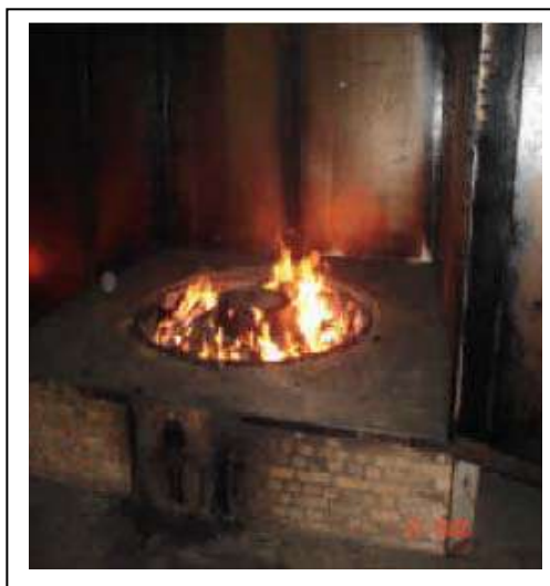
Figura 5.19 – Forno câmara muflado (esq.) e ignição na base antes de carbonizar (direita) (Santos, 2007; Bricarbras, 2006)
