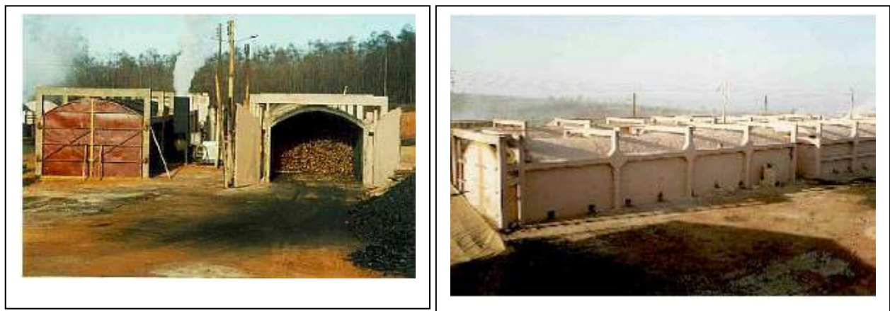
Figura 4.36 - Fornos Missouri adaptados pela Mannesmam (Ferreira, 2000)
