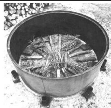
C – Uso de resíduos inflamáveis para prover 2 diâmetros de ignição/combustão
