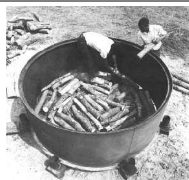
D – Operação de carregamento com lenha de tamanhos pequenos e médios para deixar o ar passar e sustentar os maiores
