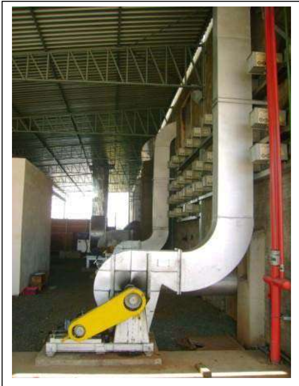
Figuras 5.22– Secador de lenha da Bricarbras com destaques para os sopradores de recirculação de ar e os magnetrons emissores de microondas (Santos, 2007)
