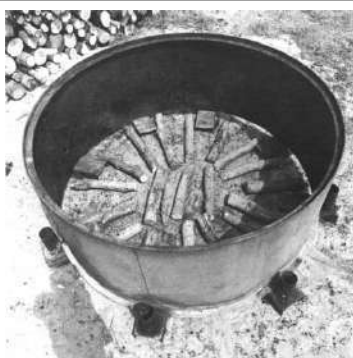
B – Enchimento com lenha, evitando entupir os 8 canais de passagem de ar/gases
