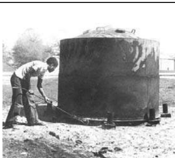
E – Acendimento dos resíduos com o forno montado e coberto
