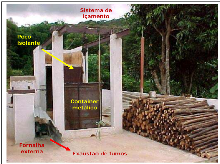
Figura 5.7 – Instalação do forno container metálico construído para ensaios de carbonização (Barcellos, 2002)
