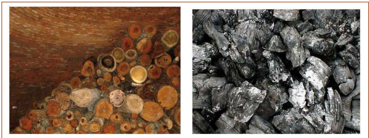
Figura 1.9 – Toras de madeira dentro do forno e aspecto do carvão vegetal produzido (Cirgell, 2010)
