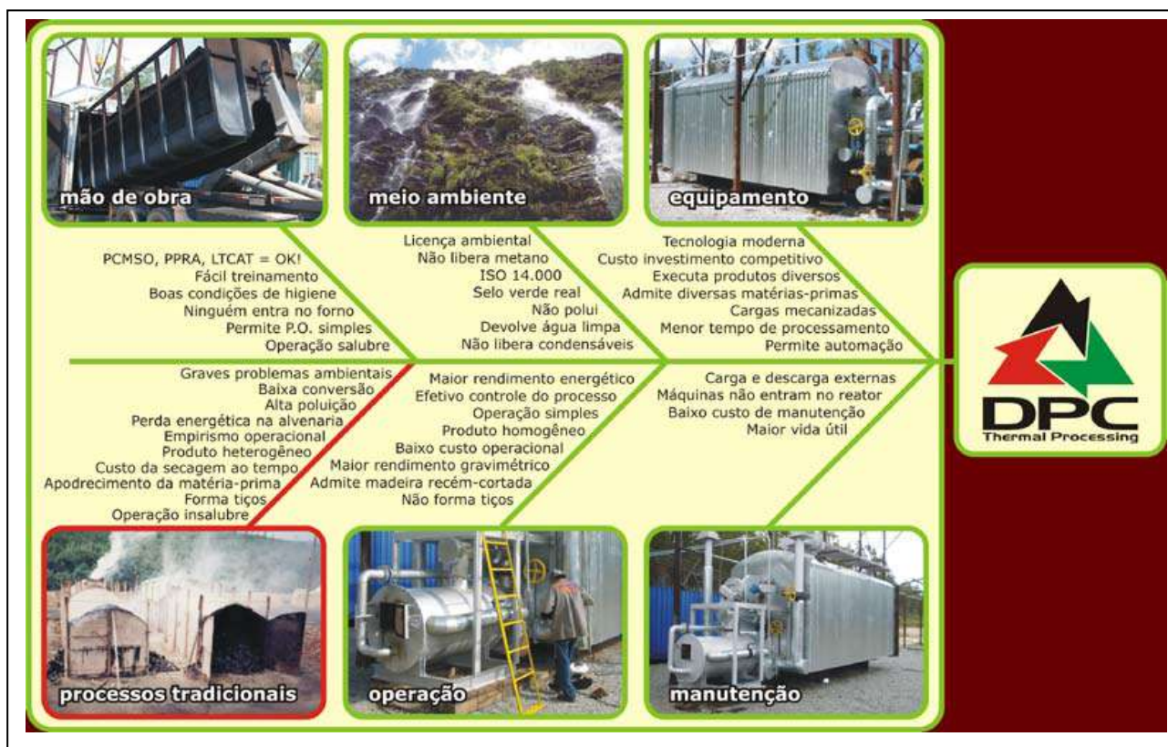
Figura 3.16 – Aspectos da tecnologia de fornos metálicos retangulares descontínuos (DPC, 2010)
