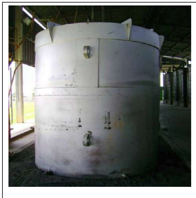
Figura 5.13 – Cilindro metálico para carbonização e uma grelha do fundo (Guimarães Neto, 2005)
