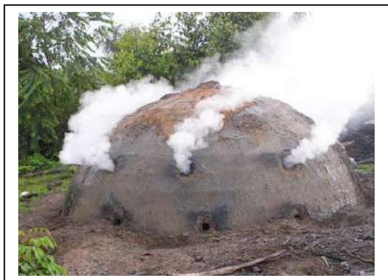
Figura 4.11 – Fumaça esbranquiçada revela início da combustão da lenha (Silva, 2006)
