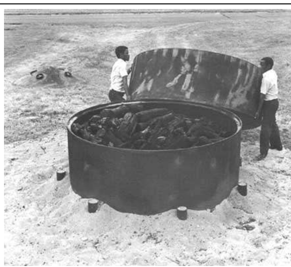
H – Desmontagem dos cilindros metálicos revelando a redução do volume à metade durante a carbonização
