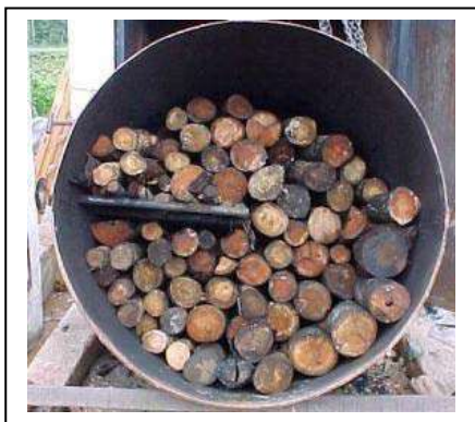
Figura 3.11– Lenha carregada no tambor metálico antes da queima e o carvão vegetal obtido. (Barcellos, 2010)
