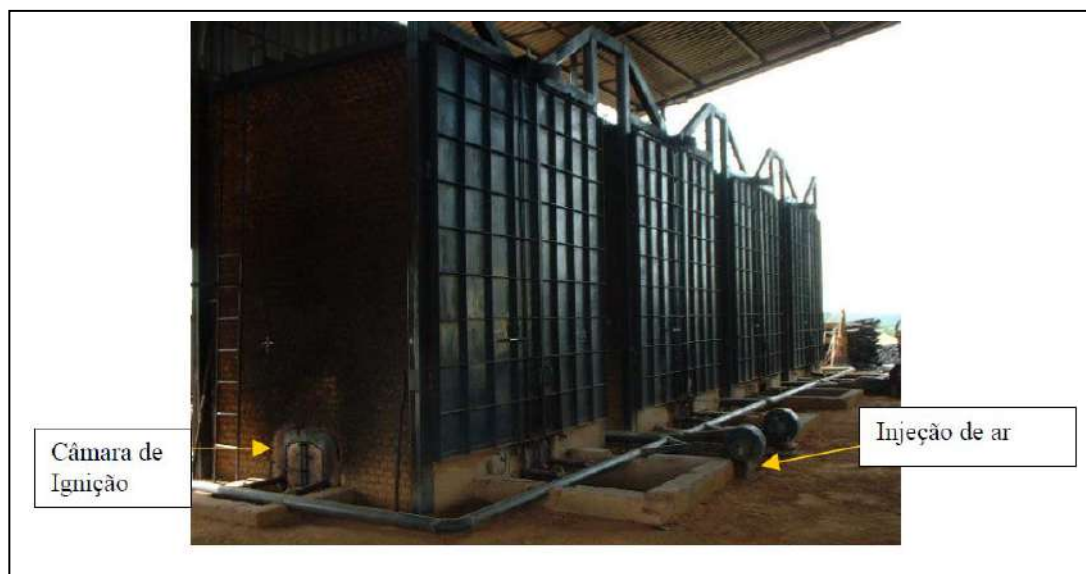
Figura 5.15 – Vista dos poços isolantes, câmara de ignição e sistema de injeção de ar (Guimarães Neto, 2005)
