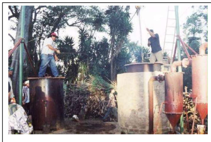
Figura 3.12 – Retirada do container de um poço após a carbonização da madeira na Nicarágua (Barcellos, 2002)
