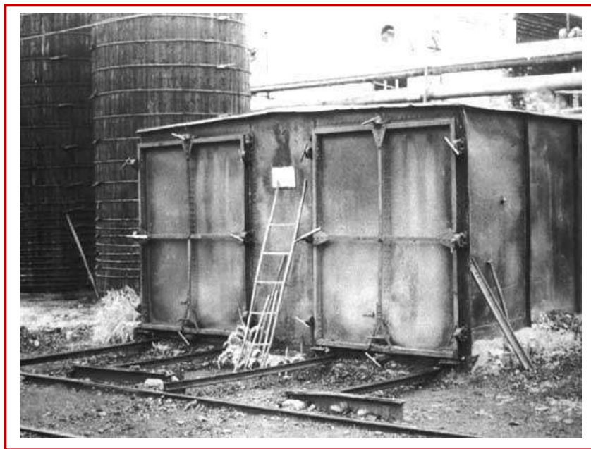
Figura 6.14 – Câmara de condensação numa unidade de processo da retorta de vagões(Suécia) (FAO, 1985)
