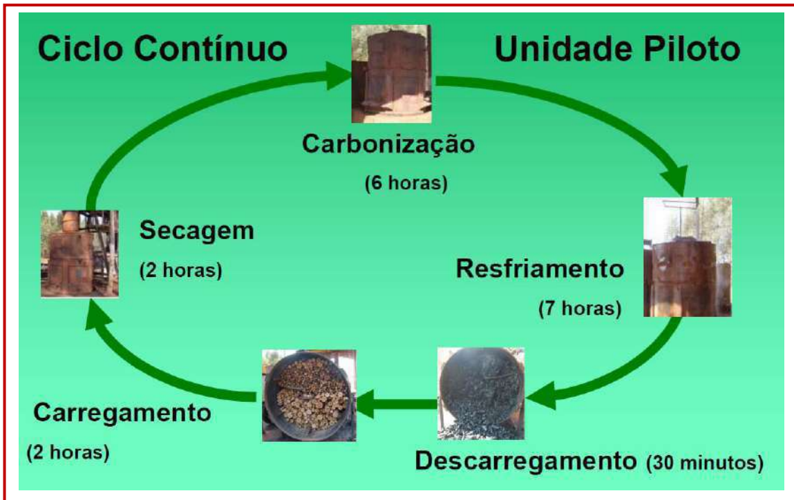
Figura 5.40 – Ciclo operacional do processo descontínuo RIMA com forno cilíndrico (Vicintim e colaboradores, 2008)
