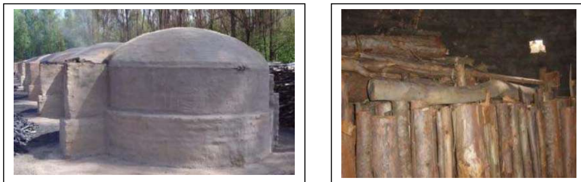
Figura 4.24 – Forno JG, diâm. 3,0m, capacidade 10 a 11 st e empilhamento vertical da lenha adotados pela SIDERSA e White Martins em baterias de 36 a 96 fornos (Bastos Filho, 2008)
