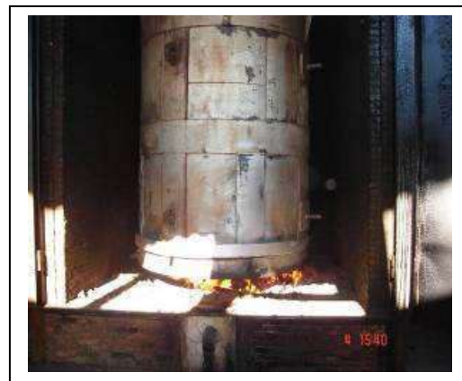
Figuras 5.24 - Sistema de movimentação e descarga de cada cilindro metálico e a base de aquecimento e câmara isolante de carbonização da Bricarbras (Colombo, Pimenta; Hatakeyama, 2006)
