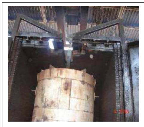
Figuras 5.24 - Sistema de movimentação e descarga de cada cilindro metálico e a base de aquecimento e câmara isolante de carbonização da Bricarbras (Colombo, Pimenta; Hatakeyama, 2006)
