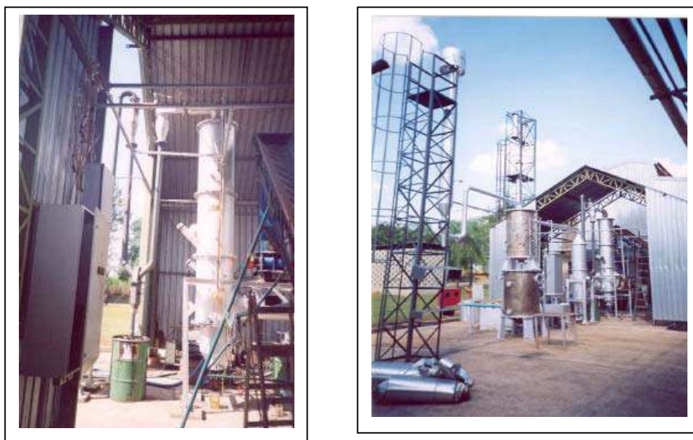
Figura 6.27 - O reator de leito fluidizado e a unidade piloto de pirólise rápida experimental da Universidade Estadual de Campinas - UNICAMP
