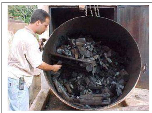
Figura 3.11– Lenha carregada no tambor metálico antes da queima e o carvão vegetal obtido. (Barcellos, 2010)
