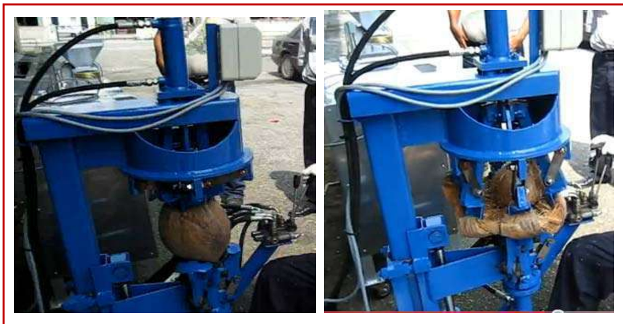
Figura 10.3 – Fragmentadora-separadora de fibras e casquilho – Method Machine Works Sdn Bhd – modelo COM 11A
