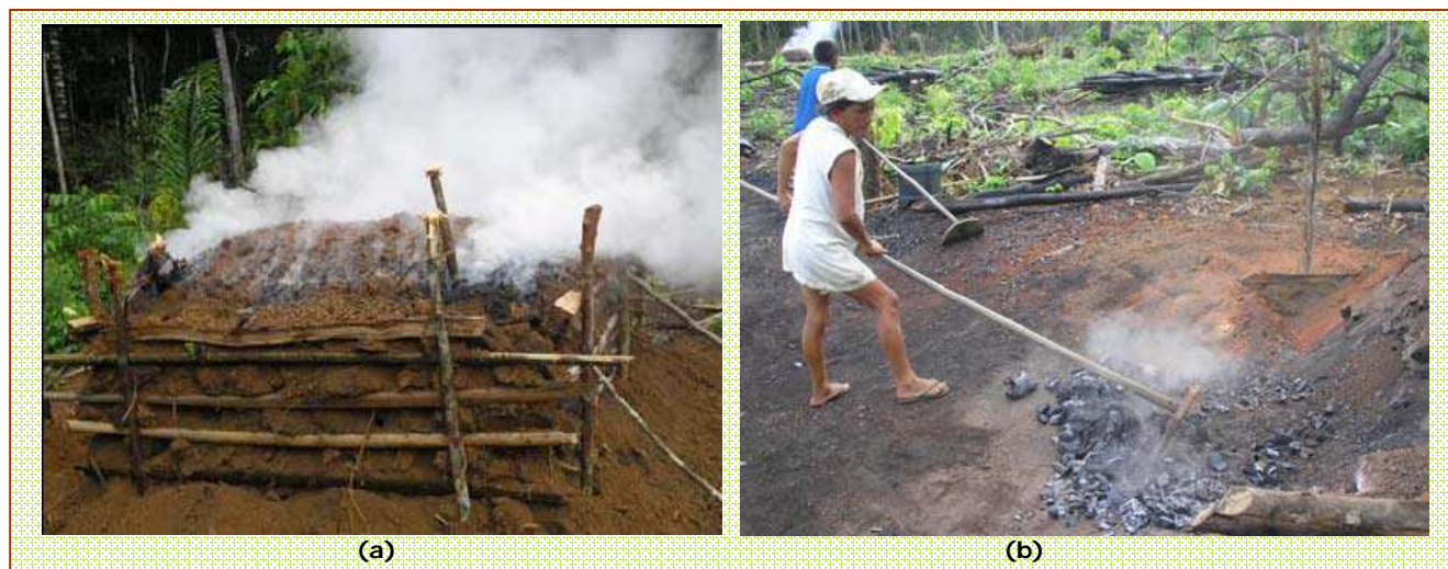
Figuras 4.3 - Produção de carvão vegetal em (a) caieira, (b) separação da terra, e (c) apagando o fogo do carvão com água (Silva, 2006)
