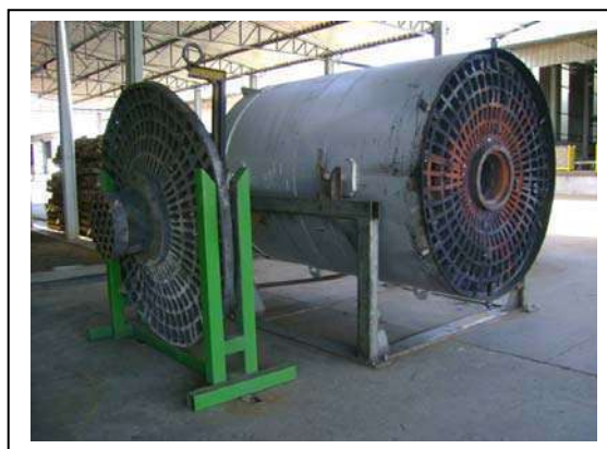
Figura 5.18 - Tampa ou grelha do cilindro de um cilindro metálico, acomodados em suportes para inspeção e manutenção (Santos, 2007)
