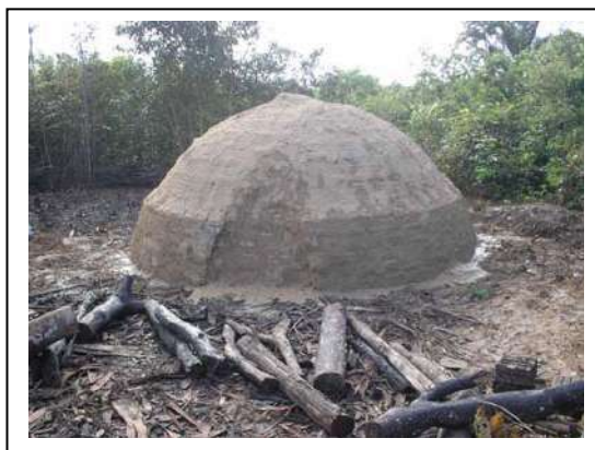
Figura 4.14 – Forno barrelado (barreado) (Silva, 2006)
