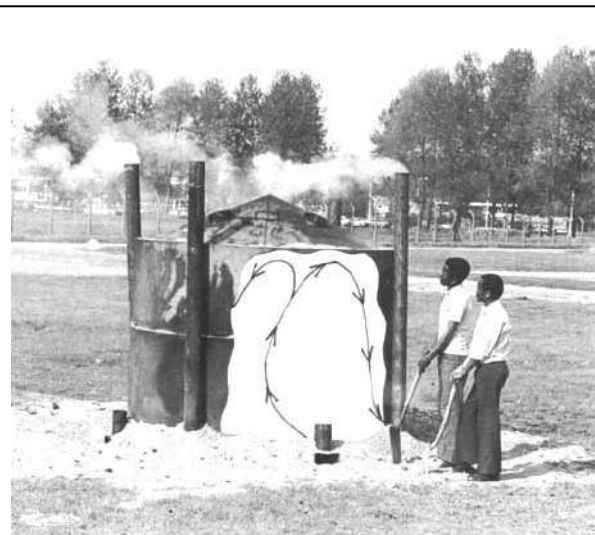
G – Representação do escoamento do ar no início da operação e dos vapores e gases emitidos durante a pirólise
