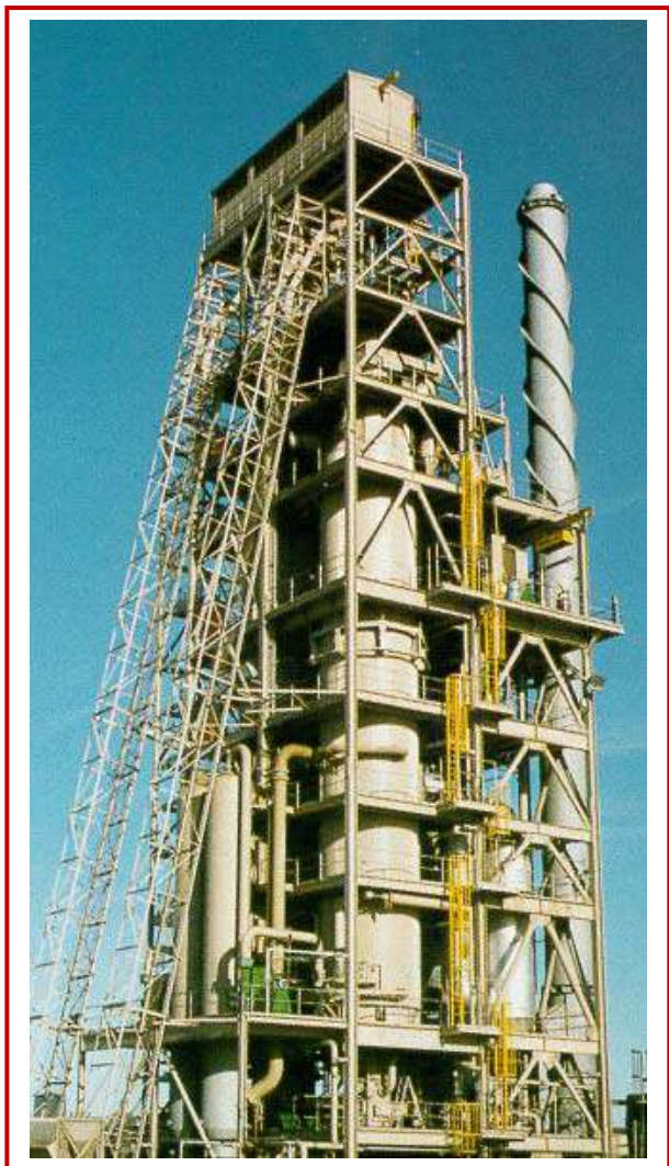
Figura 6.18 – Processo Lurgi na Austrália para produção de carvão (Gronli, 2005)
