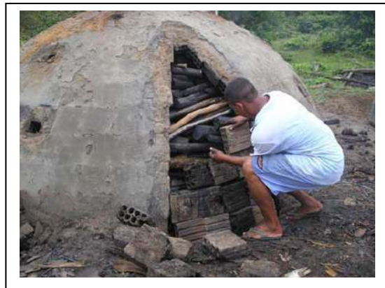
Figura 4.9 - Fechamento da porta principal antes de acender o forno (Silva, 2006)
