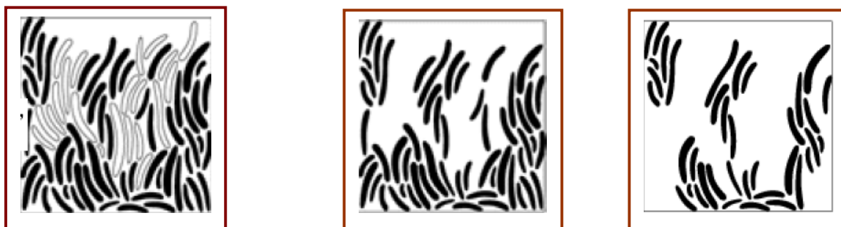
Figuras 7.5 – Arranjos obtidos na ativação de carvão vegetal com vapor d'água após tempos de ativação (A) curtos - obtém muitos microporos; (B) médios - geram muitos mesoporos; e (C) longos - produzem muitos meso e macroporos.
