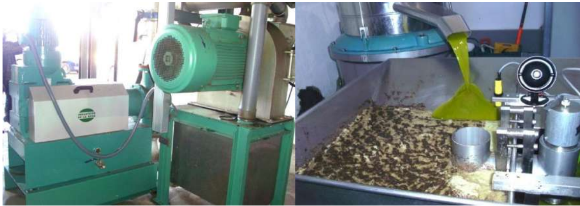
Figura 4 - Extração mecânica por moinhos de martelos
