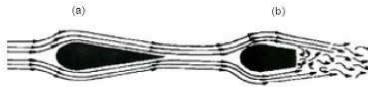
Figura 2.2- Linhas de fluxo de (a) escoamento laminar e (b) escoamento turbulento [19]
