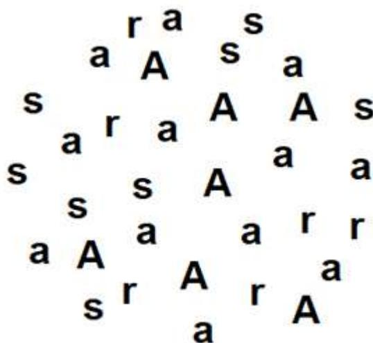
Figura 7. Imagem adaptada do modelo proposto para o arranjo de saturados (s), aromáticos (a), resinas (r) e asfaltenos (A) no RV (ELLIS *et al.*, 1998).
