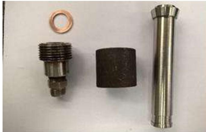
Figura 14. Composição do sistema de encaixe dos tubos
