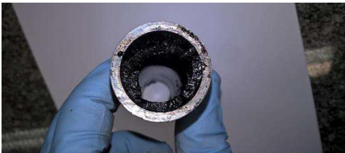
Figura 17. Imagem do sólido formado e depositado na parede do tubo do forno 2, da corrida 1 com RV A.
