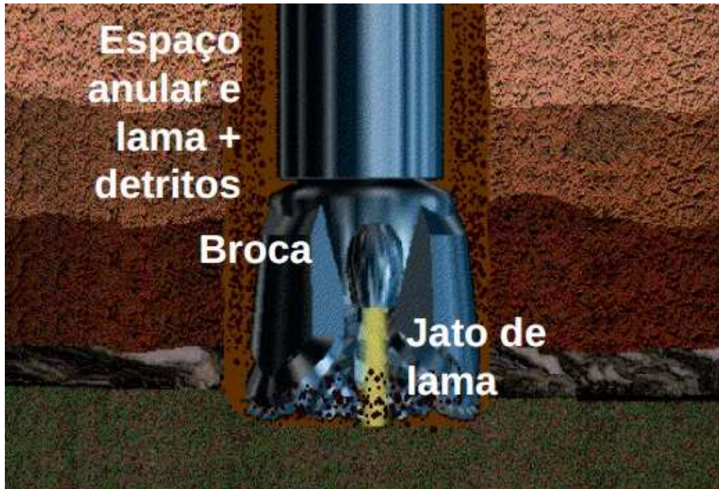
Figura 7- Carreamento de Cascalho à Superfície. Fonte: SCHAFFEL
