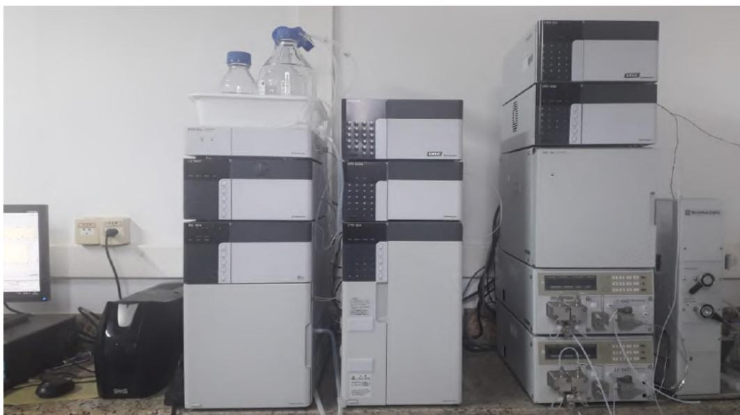
**Figura 6: Cromatógrafo líquido de alta eficiência acoplado a detector de arranjo de diodos no LPBio.**
