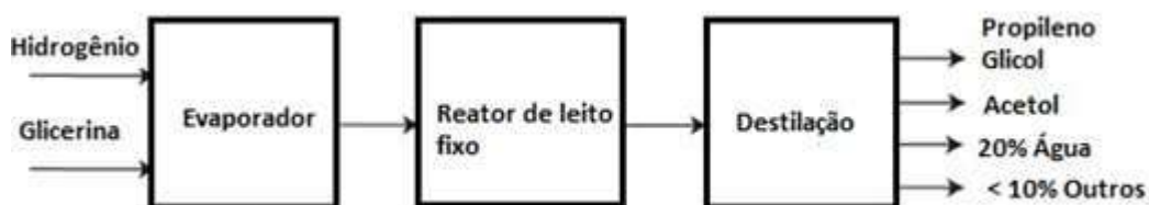
Figura 11 - Fluxograma simplificado da produção de PG pela hidrogenólise da glicerol
