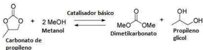
Figura 14 - Reação de obtenção de DMC e PG a partir de carbonato de propileno
