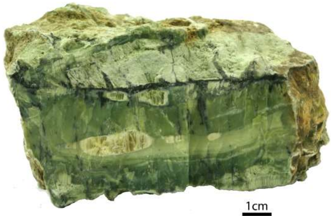
Figura 11 – Amostra bruta OCF6. A parte superior da amostra com tons verde muito claro correspondem à ganga, os veios de opala apresentam diversos tons de verde e localmente observa-se regiões formadas somente por mineral fibroso
