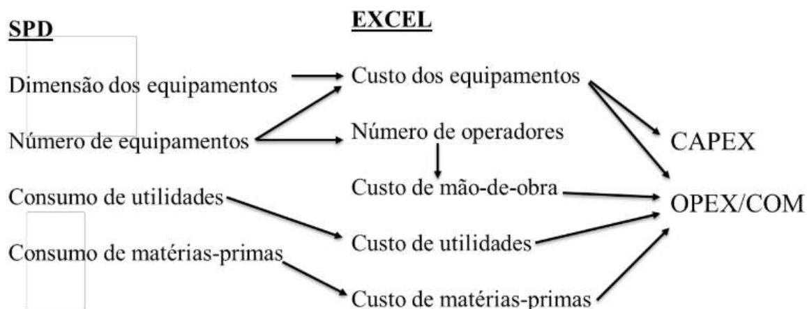
Figura 17 Fluxograma de informações necessárias para a análise econômica e suas plataformas de obtenção. Fonte: Magalhães (2019).
