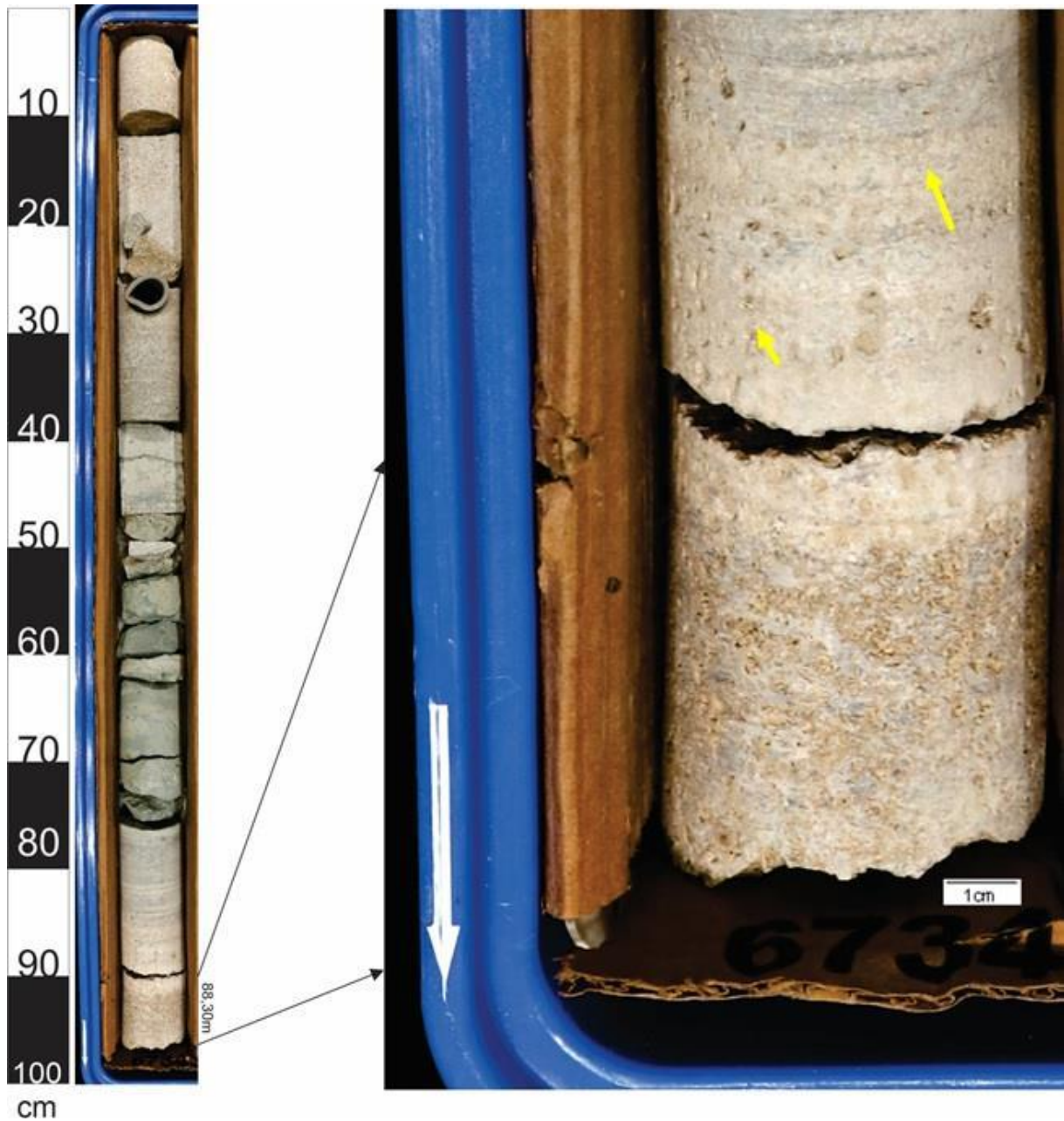
Figura 11 - Fotos dos testemunhos de sondagem do poço UFRJ-2-SMC-01-AL – profundidade 88,30 metros -fácies calcarenito médio, transição amena da coloração em creme para um acinzentado, com leve laminação plano – paralela, porosidade vugular incipiente (indicado pelas setas amarelas).
