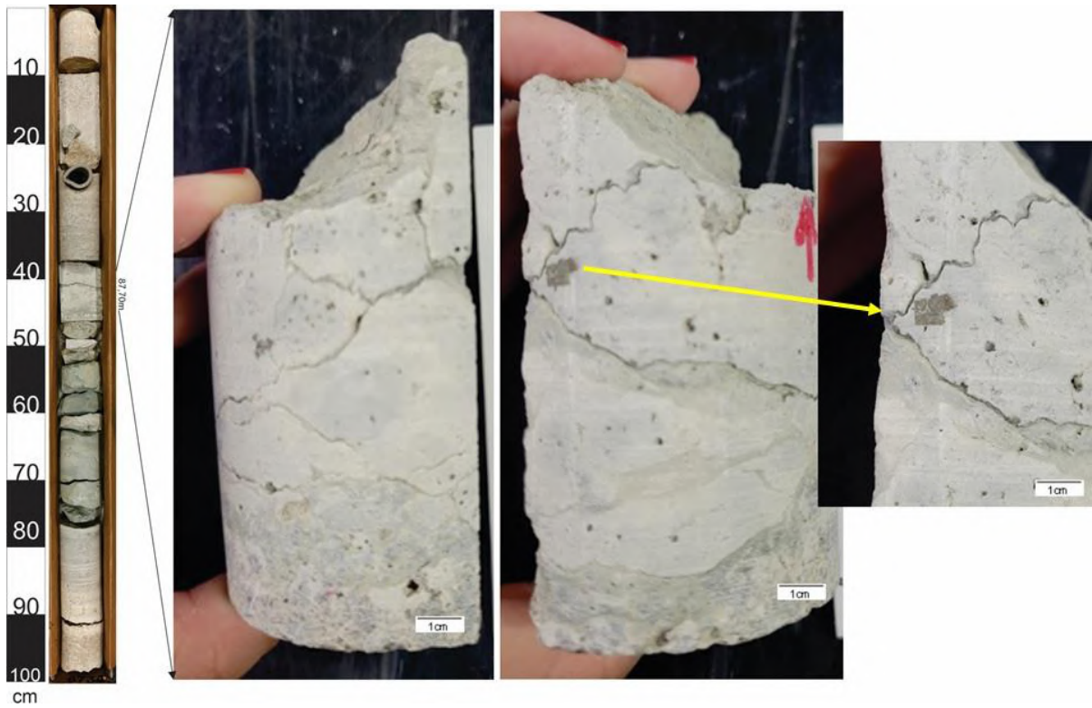
Figura 15 - Fotos dos testemunhos de sondagem do poço UFRJ-2-SMC-01-AL – profundidade 87,70m - fácies palustres, observar o aspecto nodular/brechado dessa amostra, presença de pirita euédrica (indicado pela seta amarela).
