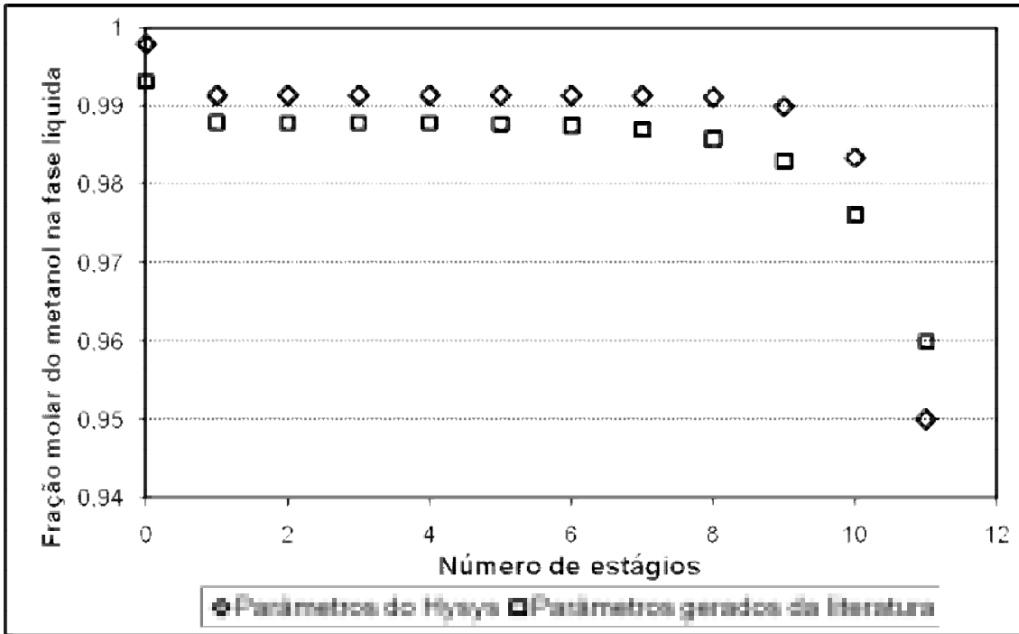
Figura 14: Fração molar do metanol na fase líquida em cada estágio na coluna T-100 para os dados retirados da literatura e os do Hysys®
