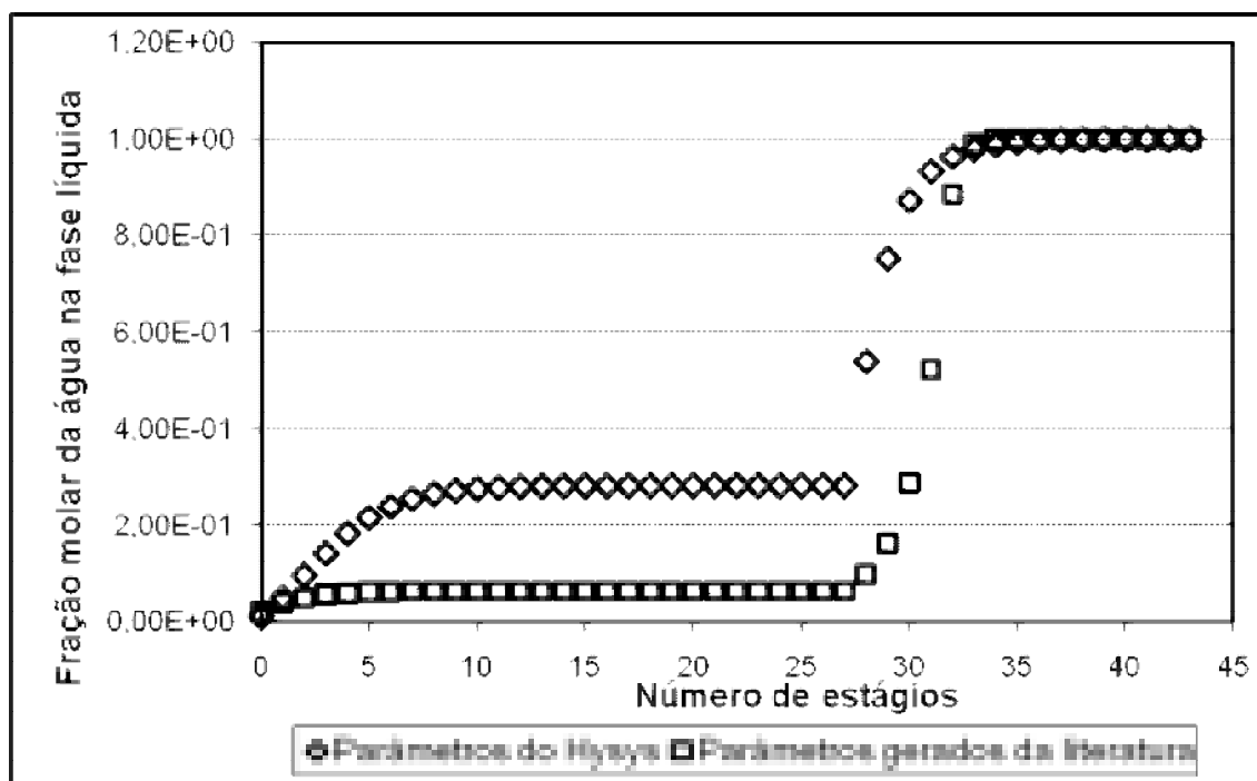
Figura 18: Fração molar da água na fase líquida em cada estágio na coluna T-101 para os dados retirados da literatura e os do Hysys®
