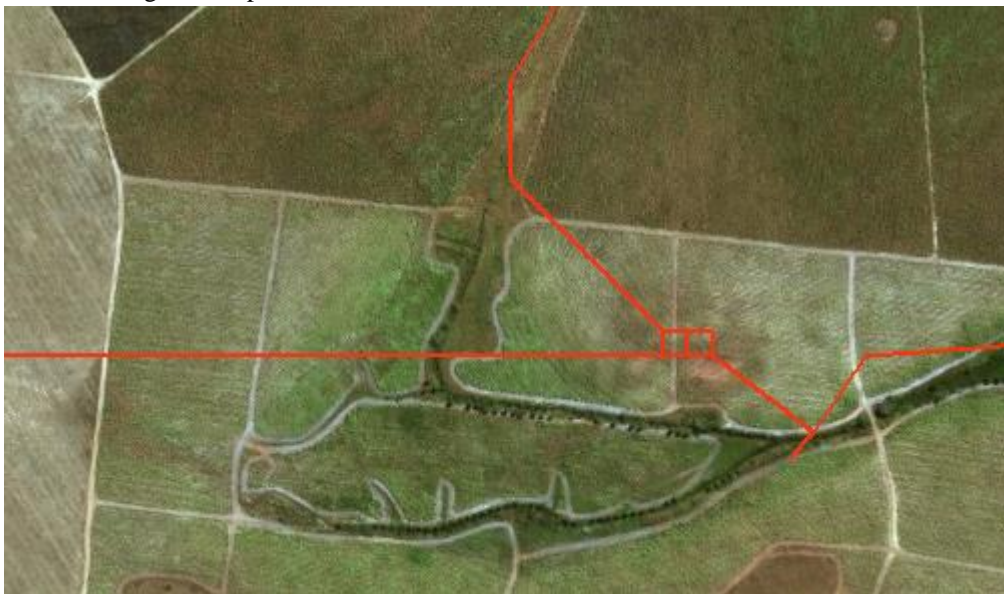
Figura 25 – Drenagens mal posicionadas
