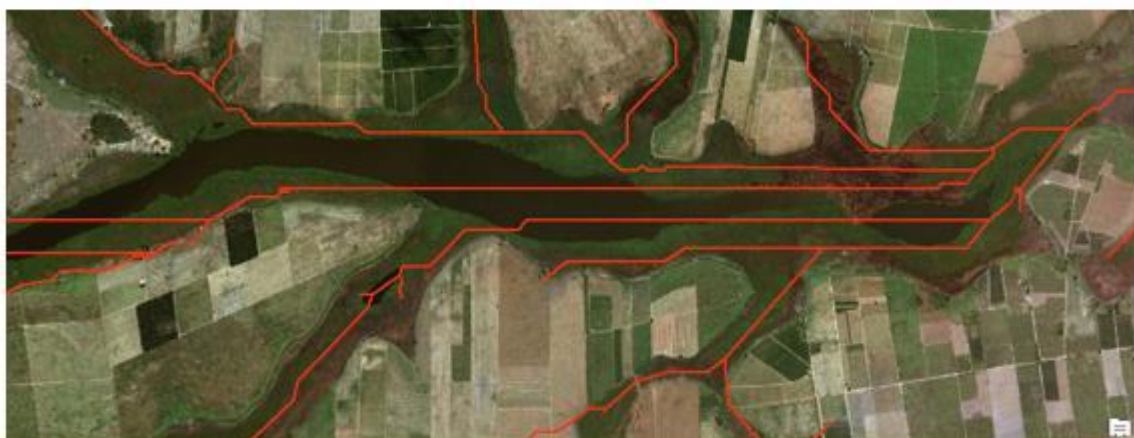
Figura 21 – Erro de drenagem em corpos d'água.
