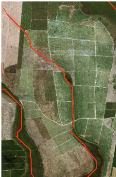
Figura 27 – Drenagem extraída automaticamente maior do que a observada em imagem de satélite.
