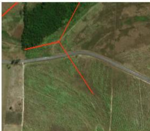
Figura 23: Duas drenagens de primeira ordem inexistentes na drenagem.
