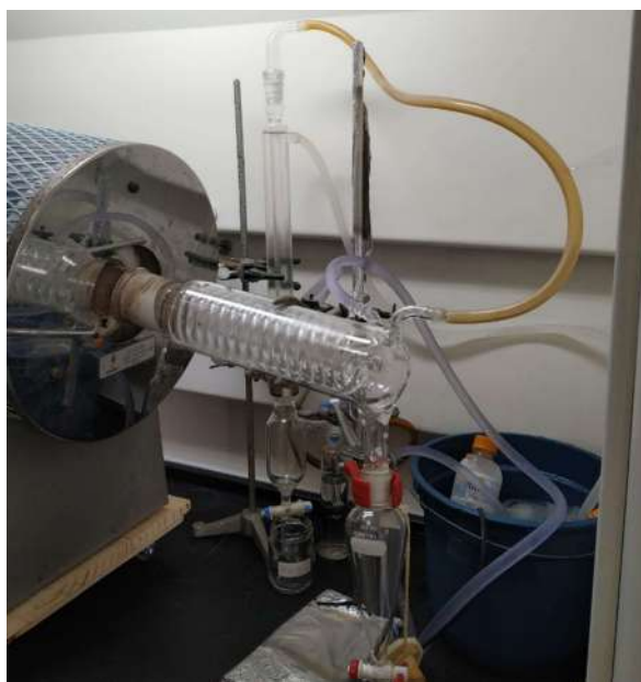
Figura 7 – Foto ilustrativa do sistema do reator de pirólise utilizado no estudo. Detalhes da montagem do condensador e funil de separação.
