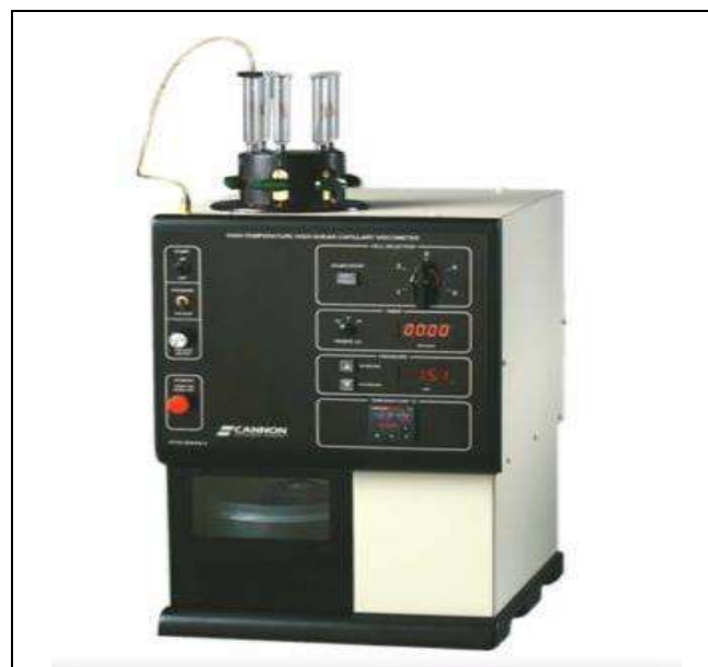
Figura 17: Equipamento Cannon HTHS SERIE 2 utilizado nos ensaios de viscosidade HTHS
