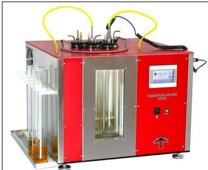
Figura 19: Equipamento Tannas Foam Aie Bath utilizado para o ensaio de formação de espuma
