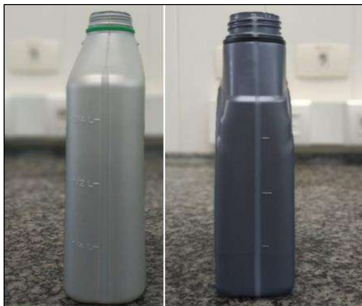
Figura 24: Visor de nível nas embalagens. A esquerda: visor de nível com indicação clara do volume correspondente. A direita: frasco do produto 10, único produto que não apresentou a indicação do volume no visor de nível.
