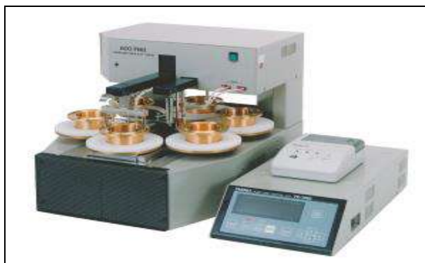
Figura 18: Equipamento Tanaka ACO-T602 utilizado para determinação do Ponto de Fulgor
