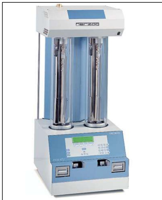
Figura 15: Viscosímetro Herzog HVM472 utilizado nos ensaios de viscosidade cinemática a 100°C e 40°C
