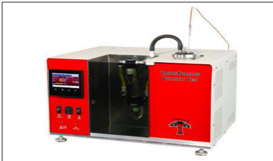
Figura 20: Equipamento Tannas Noack S2 utilizado para o ensaio de perda por evaporação
