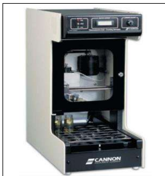
Figura 16: Equipamento Cannon CCS 2100 utilizado nos ensaios de viscosidade CCS a -25°C
