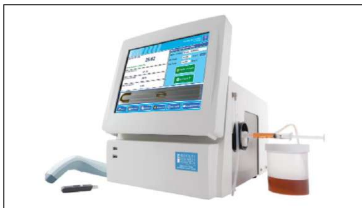
Figura 14: Equipamento Rudolph Research Analytical DDM 2911 utilizado nos ensaios de densidade
