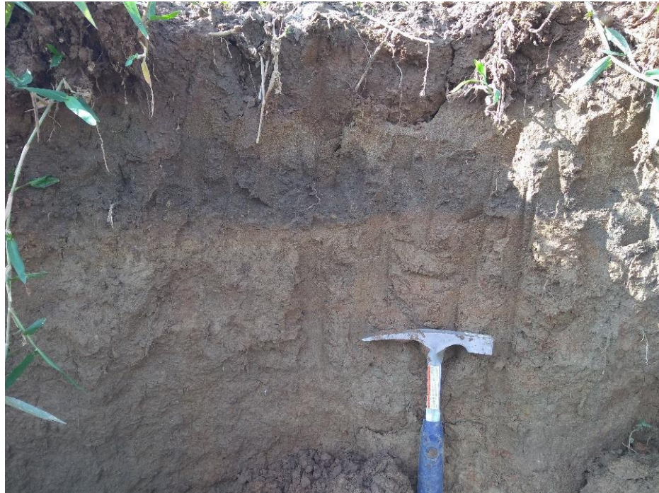
Figura 31: Afloramento do ponto 4, observando-se contraste entre sedimentos areno-lamosos abaixo (depósito típico de planície de inundação) e sedimentos arenosos mais escuros acima.
