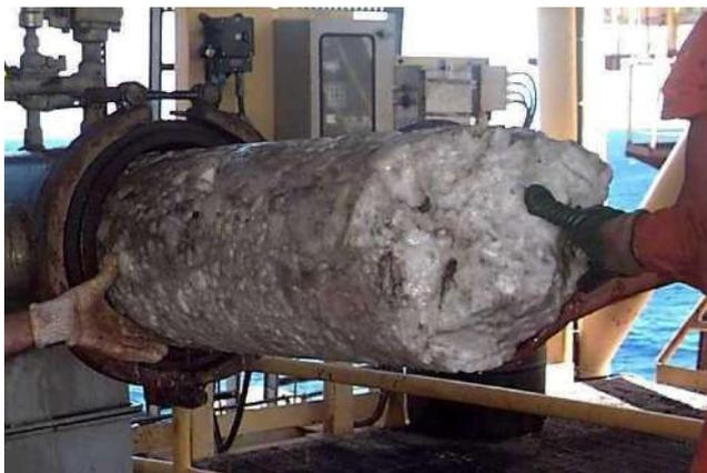
**Figura 2. Bloqueio da linha por hidrato em unidade de produção (VAZ, 2009).**
