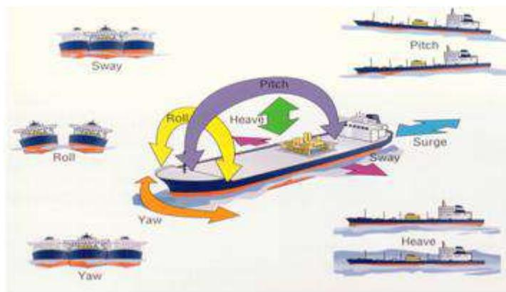
**Figura 8. Tipos de movimento de um FPSO devido à incidência das ondas do mar (AMBROSIO, 2007).**
