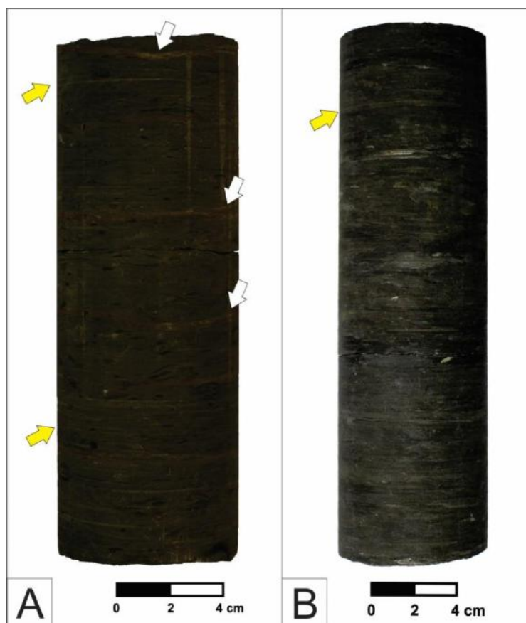
Figura 13 – Fácies Ab: argilito e argilito síltico bioturbado. Destaca-se na fotografia (A) (427,00 m) a presença de níveis de siderita, alguns destacados pelas setas brancas, além das delgadas lâminas de silte que marcam a laminação plano paralela (setas amarelas). Observe que na base da amostra há maior frequência das lâminas, enquanto no topo a ocorrência diminui. Na fotografia (B) (374,20) há maior obliteração de características primárias pela bioturbação, apresentando preservação pontual das lâminas de silte (seta amarela).
