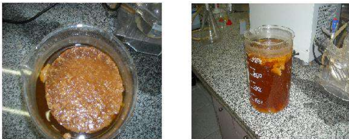
Figura 41 - Lignina com pré-tratamento térmico de 60 °C por 14 h; vista superior (à esquerda) e vista lateral (à direita).
