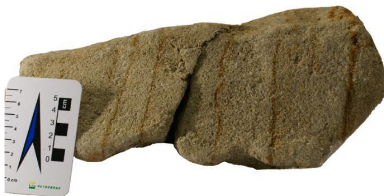
Figura 23 - Foto do bloco de arenito deformado BD#1/2, destacando as faixas de cimentação por óxidos de ferro que acompanham estruturas do tipo bandas de deformação.
