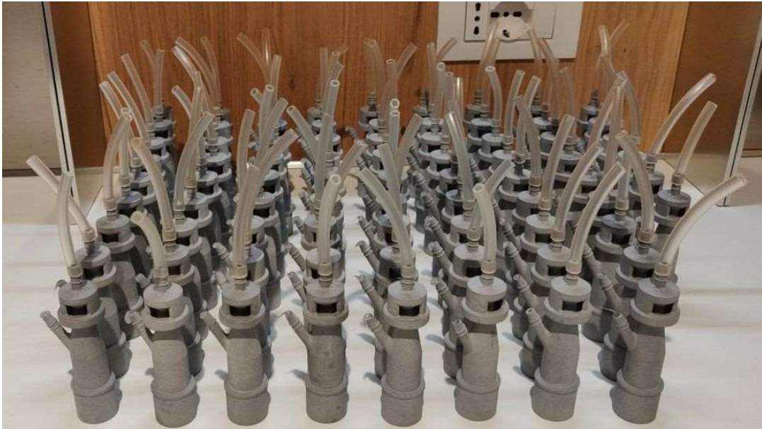
Figura 18 - Válvulas de respiradores produzida pela impressora 3D
