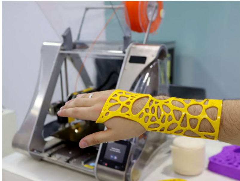
Figura 10 - Órtese da Fix It produzida com impressora 3D
