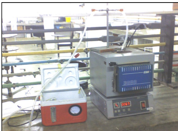
Figura 2.7 – Sistema completo de amostragem para a coleta dos diferentes tipos de COVs.
