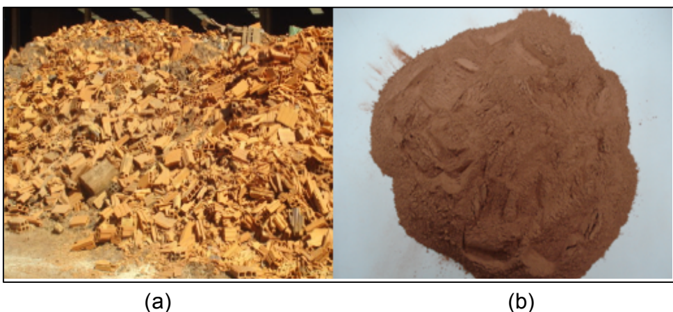
Figura 2.1 – Aspectos da matéria-prima utilizada: sobras de tijolos da construção civil (a) após cominuição (b).
