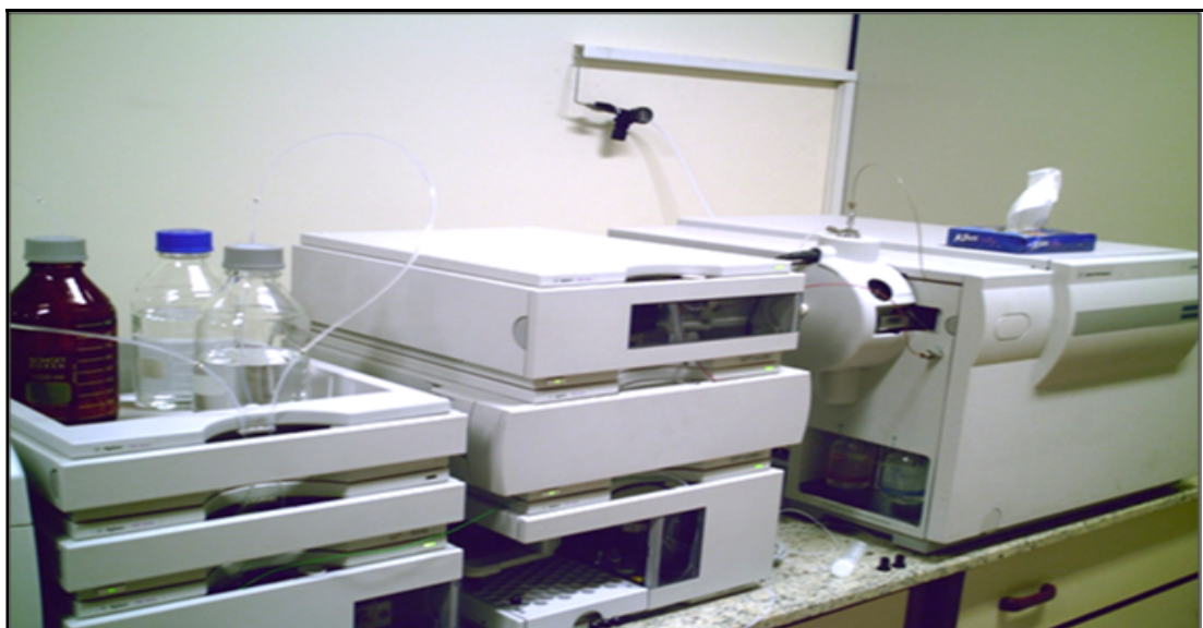
Figura 2.12 – Cromatógrafo Líquido Agilent 1100 utilizado para as análises dos aldeídos.
