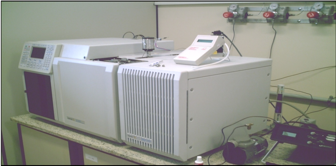
Figura 2.9 – Cromatógrafo Varian GC CP-3800 utilizado para análise dos BTEX.
