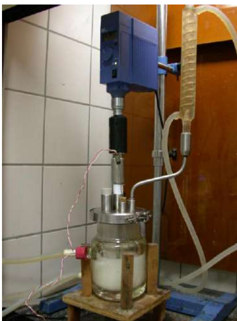
Figura 7: Foto do reator utilizado para produção do PMMA.
