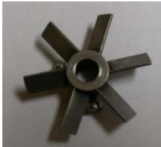
Figura 9: Fotografia do impelidor de 6 pás inclinadas utilizado em algumas reações de polimerização.
