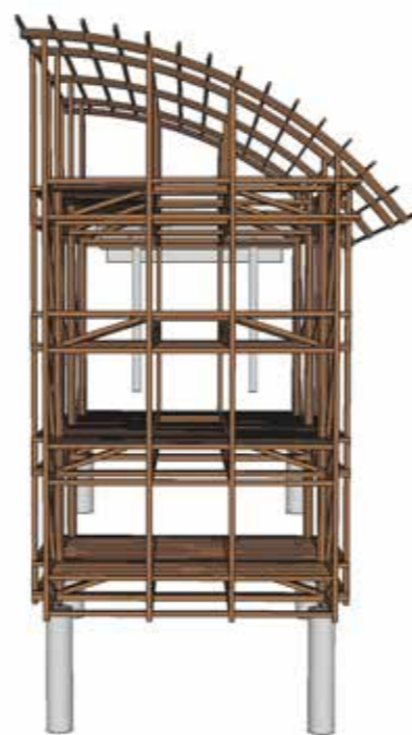
modelo 3d que mostra toda a estrutura dos pilares, pórticos e fundação. elaborado por Aflalo
