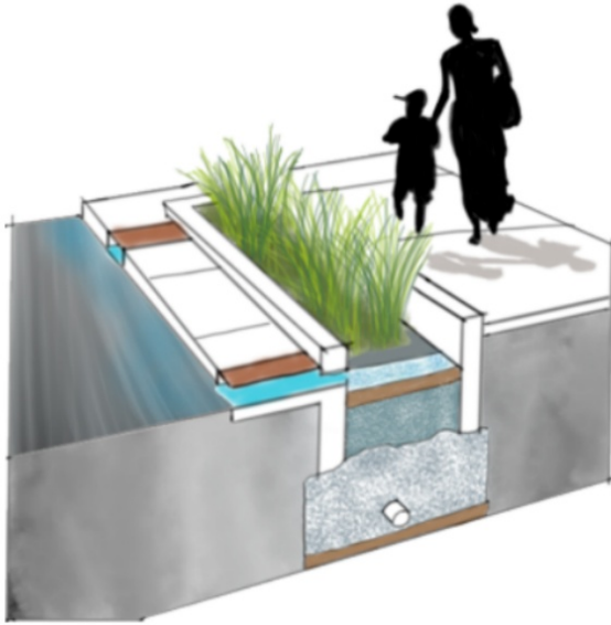
Croqui de representação do escoamento dos jardins de chuva ao longo de calçadas lineares
