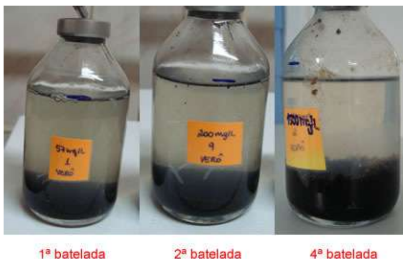
Figura IV.13 – Frascos de penicilina empregados no tratamento anaeróbico com choque de gordura.
