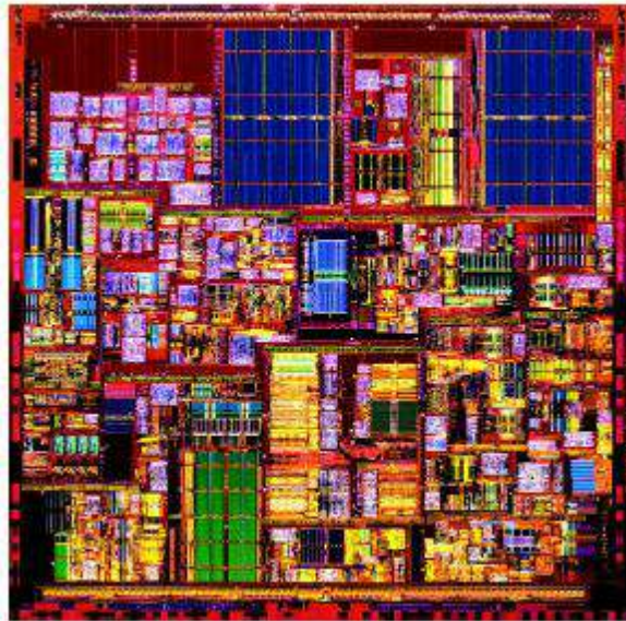
Figura 7 – Pentium 4: 168 milhões de transistores em 200 mm 2
