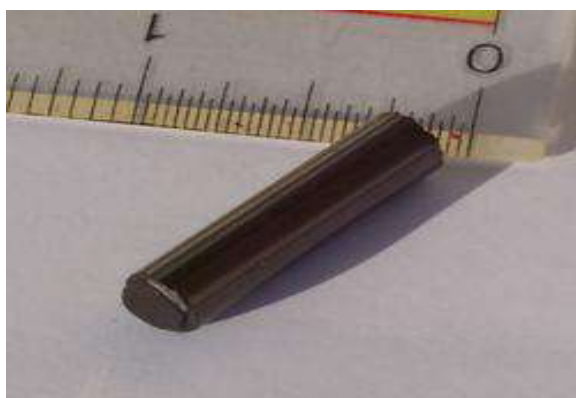
FIGURA 29 - FOTO DE UMA ESTRUTURA DE CARBONO VÍTREO (FONTE: HTTP://WWW.FEM.UNICAMP.BR/~LEE/INFRA_ESTRUT.HTM ).
