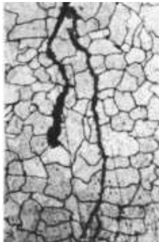
Figura II-XVI Corrosão intragranular ou transcristalina em aço inoxidável submetido à ação de cloreto e temperatura (FERREIRA et al, 2002).
