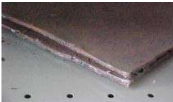
Figura II-XXI Tubo de aço carbono com empolamento pelo hidrogênio, causado pelo H_2S e água (FERREIRA et al, 2002).
