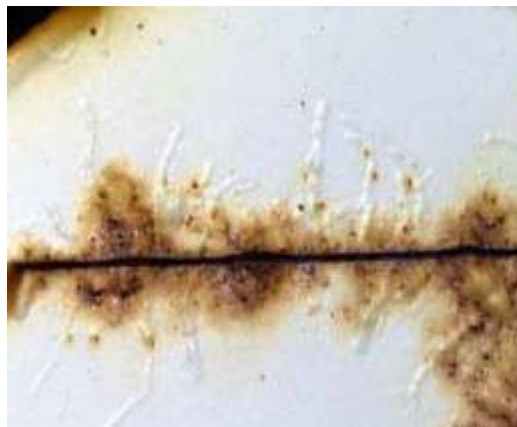
Figura II-XVIII Corrosão filiforme (MAINER, 2010).
