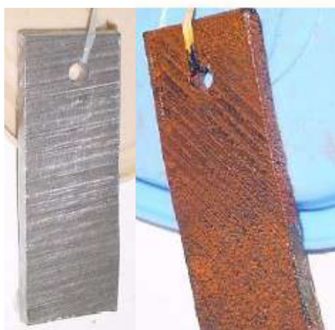
Figura II-X Corrosão uniforme em placa – antes e depois (MAINER, 2010).
