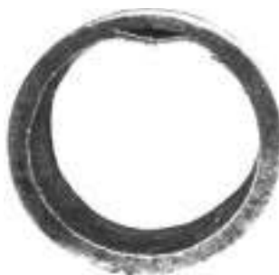
Figura II-XXI Tubo de aço carbono com empolamento pelo hidrogênio, causado pelo H_2S e água (FERREIRA et al, 2002).
