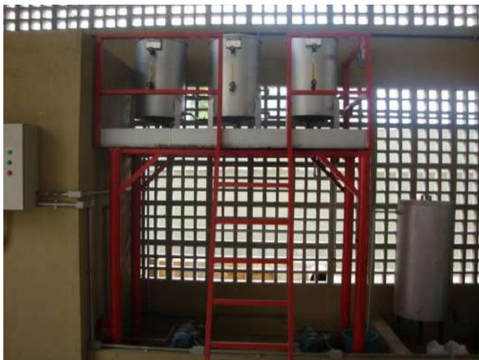
Figura 12. Tanques de armazenamento de biodiesel.
