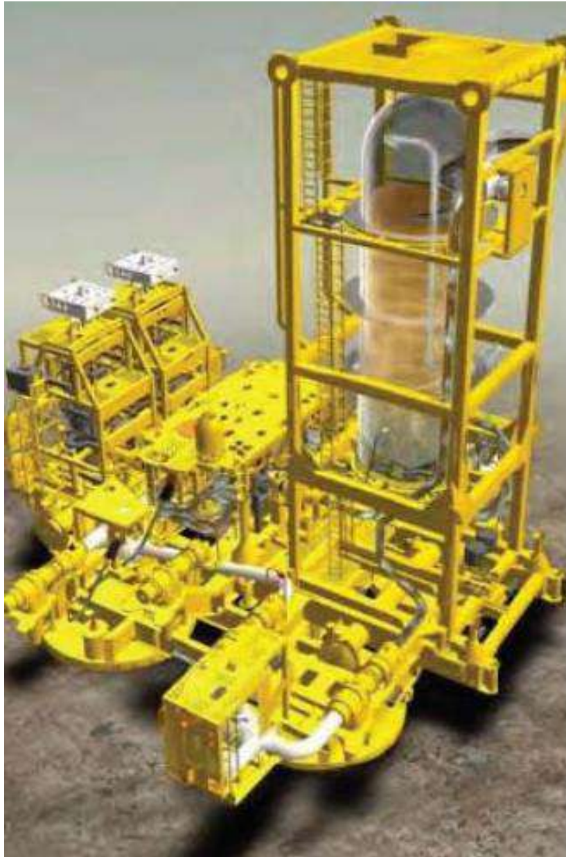
Figura 27 - Esquema do separador de Pazflor
