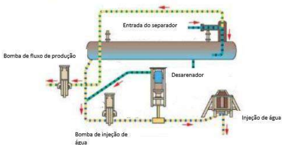
Figura 22 – Esquema do separador de Tordis
