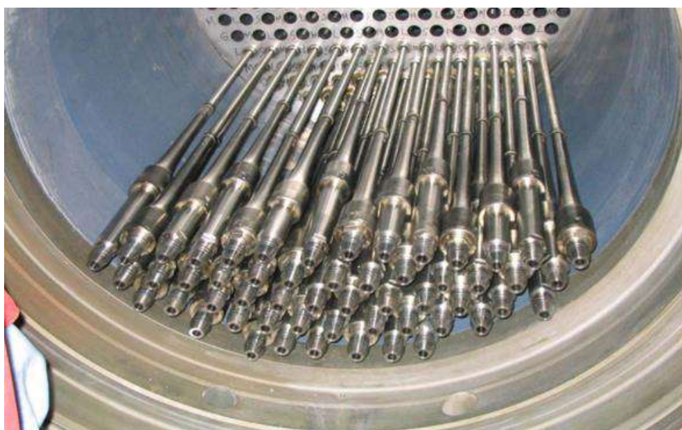
Figura 16 – Liners: hidrociclones em paralelo
