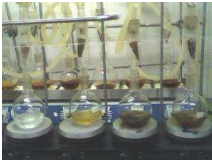
Figura III.3 Fotografia da segunda lavagem com n-heptano na Extração de Asfaltenos. O balão no canto esquerdo representa o início da lavagem, quando o solvente foi adicionado ao balão. Já os outros balões correspondem ao decorrer da lavagem.
