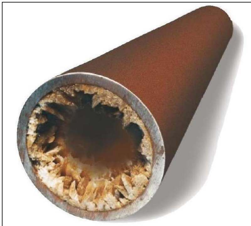
Figura II.2 – Incrustação em uma tubulação [8]
