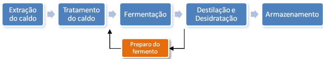
Figura 1: Diagrama de blocos simplificado do processo de produção de etanol de 1ª geração.
