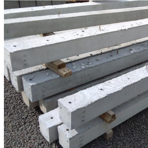
3. PILARES EM CONCRETO
