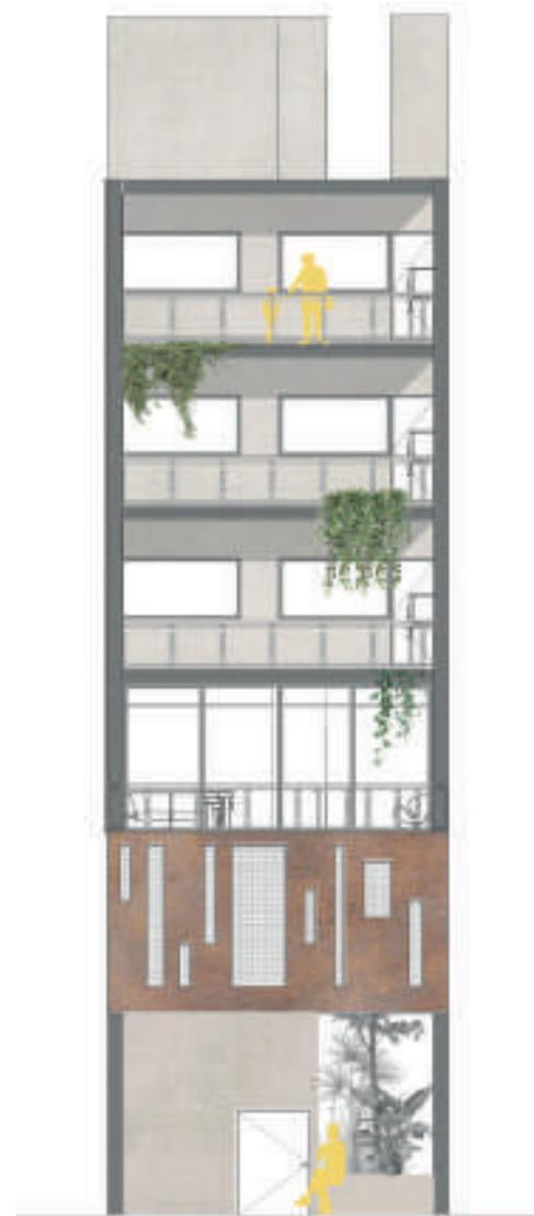
Na fachada de frente à R. Visconde de Inhaúma propõe-se a criação de uma fachada fixa superior em aço cortén, de modo a marcar a testada do lote e o início do percurso de galeria. O térreo será livre, fechado por completo durante o período da noite, através do uso de porta camarão.
