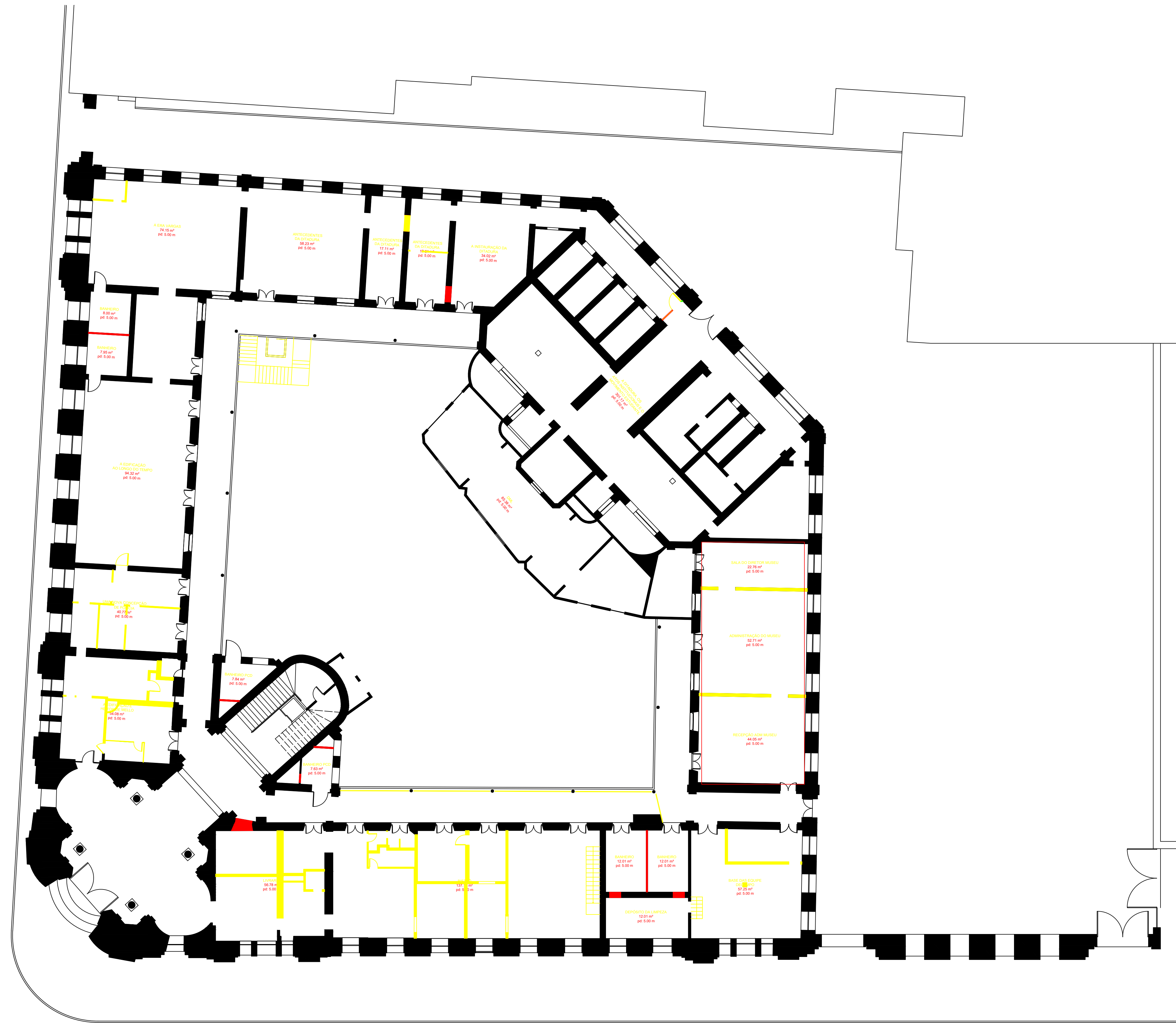
01 PLANTA BAIXA - TERREO - DEMOLIR/CONSTRUIR
