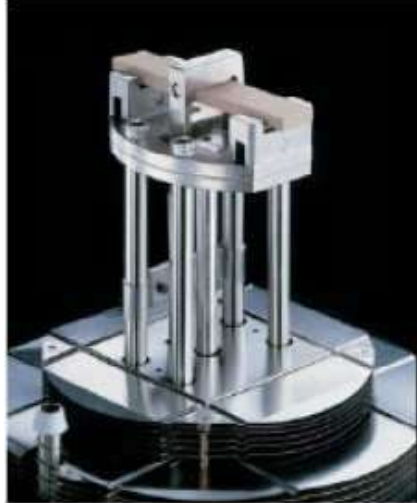
Figura 32 - Garra do tipo flexão em três pontos do equipamento Q-800 da TA Instruments (Zaioncz, 2009).
