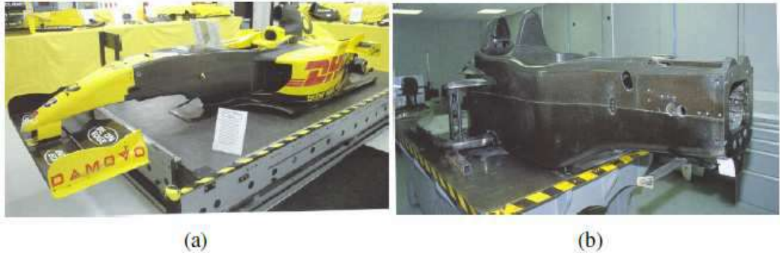
Figura 12 - Dianteira (a) e chassi (b) de um carro de Fórmula-1 de 2004 (Romariz, 2008).
