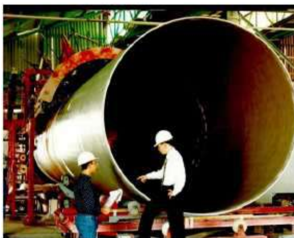
Figura 21 - Processo Drostholm (Silva, 2008).
