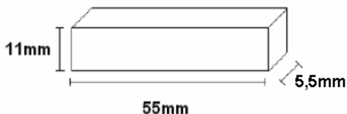
Figura 31 - Dimensões do corpo de prova do teste de impacto instrumentado.
