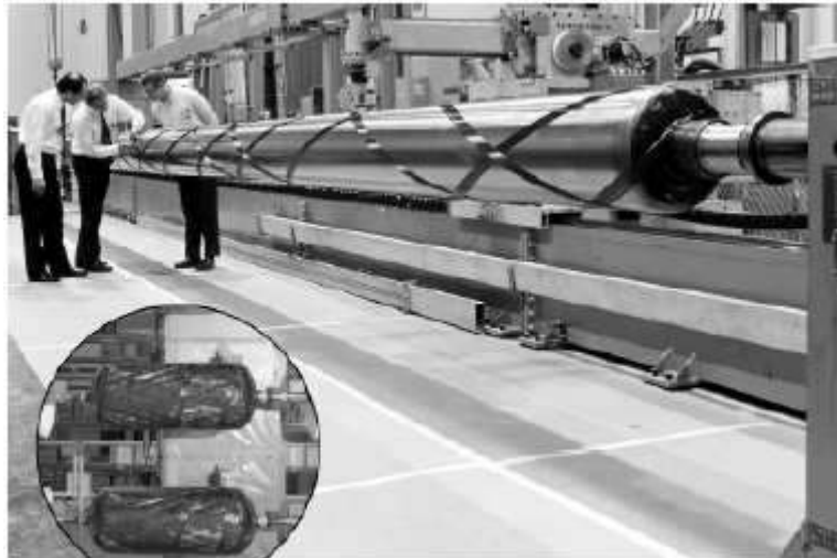
Figura 23 - Processo de enrolamento por prepreg (Silva, 2008).
