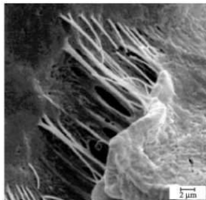
Figura 7 - Microscopia de superfície de fratura criogênica do polietileno de alta densidade tenacificado (Guimarães, Rocha et al. , 2002).
