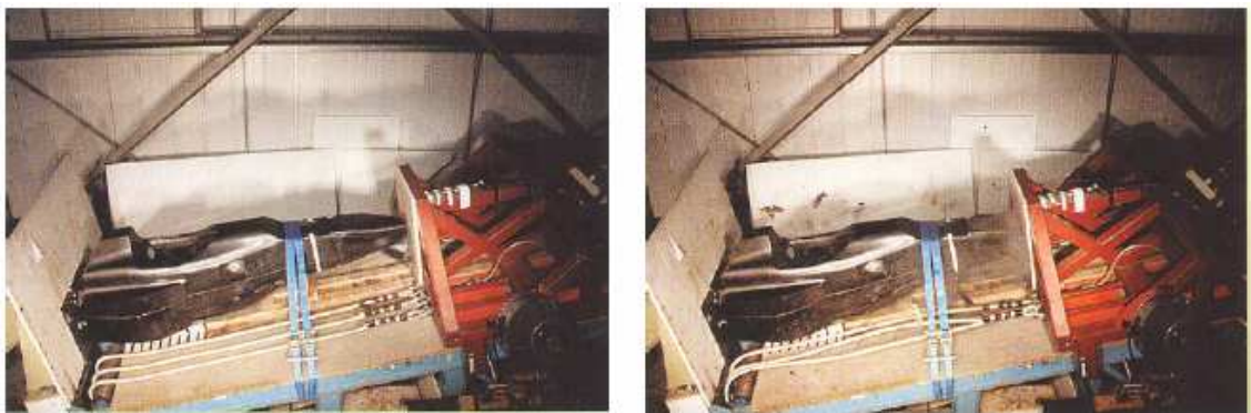
Figura 13 - Ensaio de impacto do nariz e chassi de um carro de Fórmula-1 (Tremayne, 2004).
