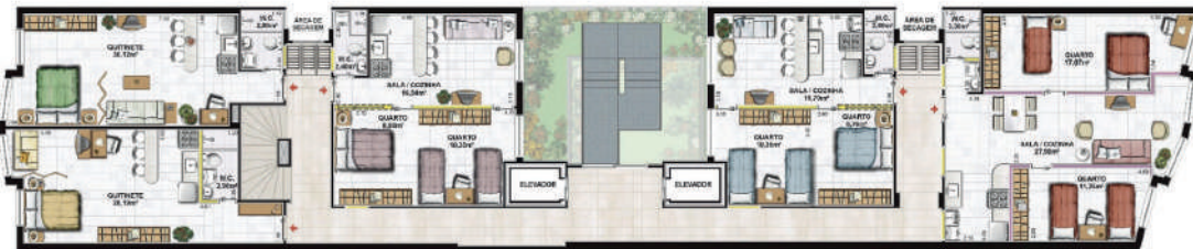
Figura 15 — 3º ao 7º pavimentos. À esquerda, unidades do tipo quintete; à direita, unidades de um quarto (convertível em dois) e de dois quartos. Sem escala. Imagem: NAPP (Núcleo de Assessoria, Planejamento e Pesquisa). Marcações da autora..
