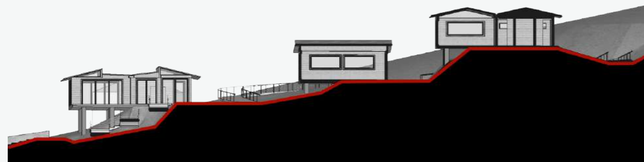
CORTE BB MOSTRANDO A MOVIMENTAÇÃO DE TERRA, EM UM DOS PONTOS MAIS CRÍTICOS FONTE: ELABORADO PELA AUTORA
